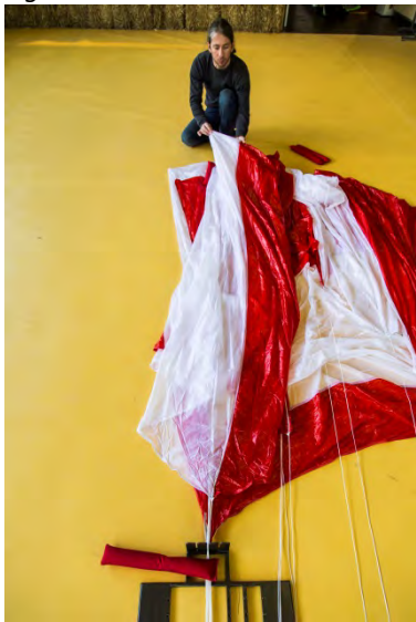
Fig. 68 Fijar suspenste del Panel 3 en el rastillo
