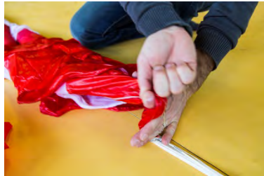
Fig. 112-115 Envolver todos los suspenes con el primer panel asegurarlo con un elástico y dejarlo sobre el ala
