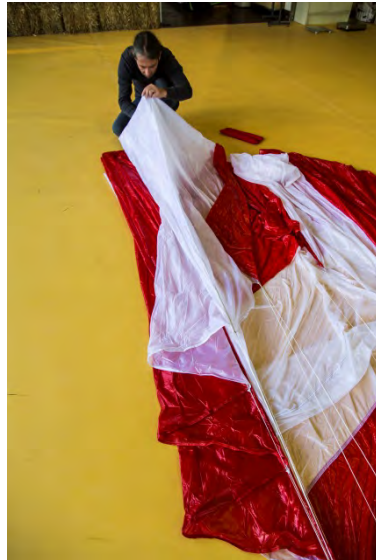
Fig. 75-77 El pliegue de los siguientes paneles sigue hasta la punta de ala ...
