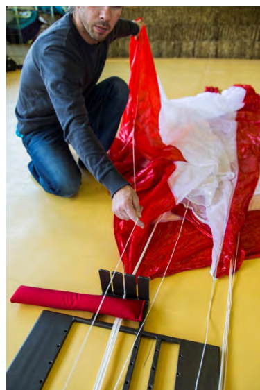
Fig. 55 Fijar el suspente del panel Nr.1 en el rastillo.
