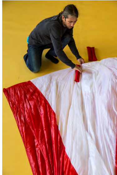
Fig. 57 Colocar la costura en el eje
