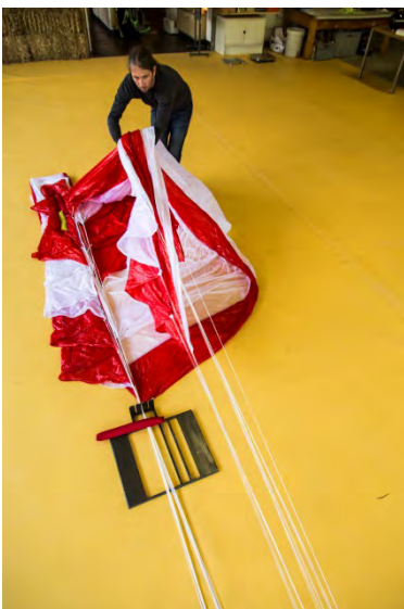
Fig. 80-82 Colocar la mitad de ala incluyendo los suspensores al lado opuesto sobre el rastillo
