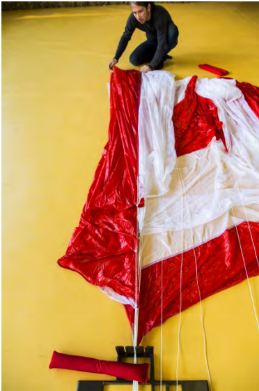
Fig. 74 Fijar suspenso en el rastillo
