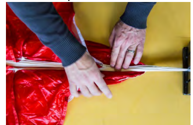
Fig. 85 Controlar funcionamiento libre de suspenes...
