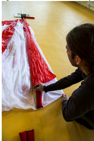
Fig. 57 Colocar la costura en el eje
