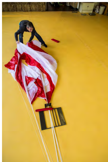
Fig. 80-82 Colocar la mitad de ala incluyendo los suspensores al lado opuesto sobre el rastillo
