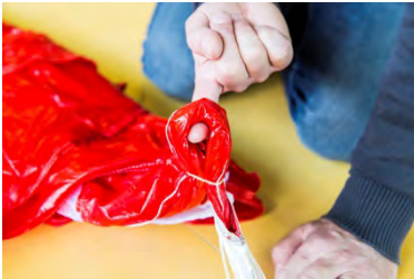
Fig. 112-115 Envolver todos los suspenes con el primer panel asegurarlo con un elástico y dejarlo sobre el ala
