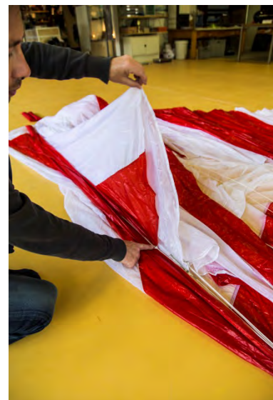
Fig. 64 Colocar la conexión del suspente del panel Nr.2 sobre las cuerdas centrales
