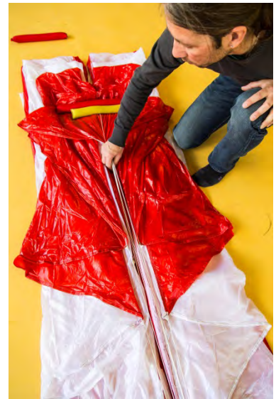
Fig. 85 Controlar funcionamiento libre de suspenes...
