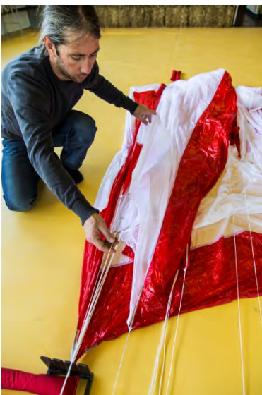
Fig. 62 Seguir el borde de la base del segundo panel
