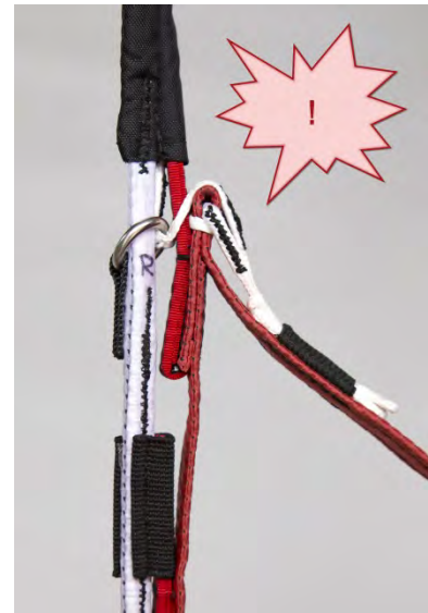
Fig. 16 Guardar el pico fuera de la argolla de metal
