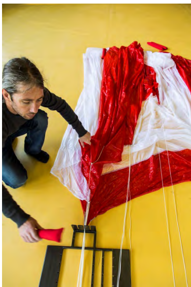
Fig. 71 Fijar suspenste del Panel 4 en el rastillo
