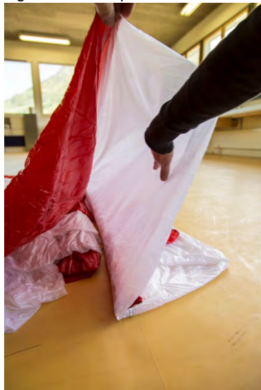
Fig. 69 Alisar para afuera el panel Nr. 3 (pliegue en S)
