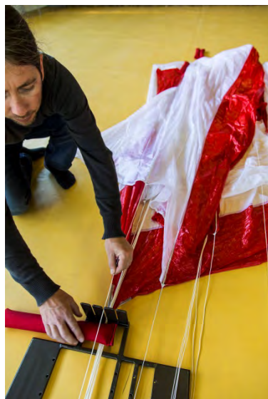
Fig. 63 Suspente Nr. 2 fijar en el rastillo
