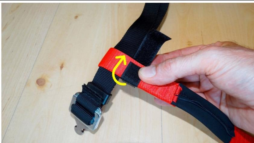
Schiebe den Beingurt ans Ende der Schlaufe des neuen Safe-T straps und lege das Klettband, bündig mit dem Beingurt, über den neuen Safe-T strap.
