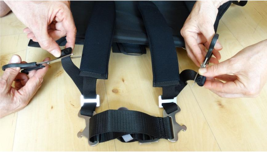
Um den Brustgurt auszubauen müssen zunächst die Beingurte aus den Schnallen, die sie mit dem Brustgurt verbinden, ausgefädelt werden. Durch die Nähte am Ende der Beingurte ist das aber nicht möglich, deshalb musst du die beiden Enden, wie auf dem Foto abgebildet, abschneiden. Versuche so genau wie möglich zu schneiden, das erleichtert das nun folgende Verschmoren der Kanten.
