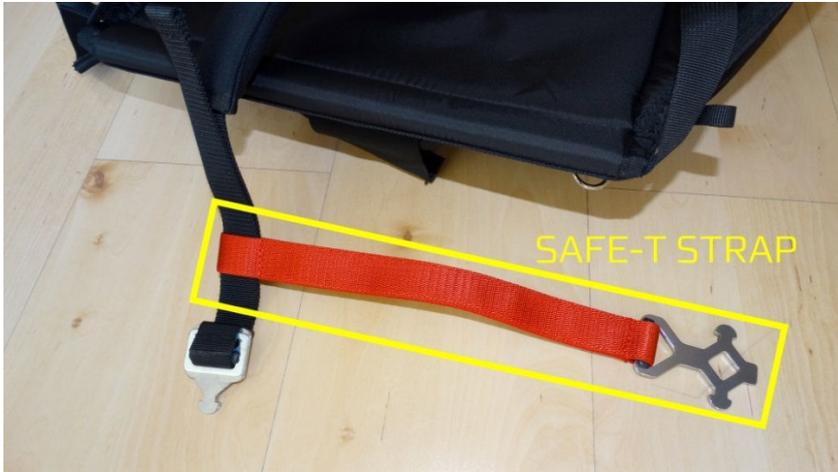
So ersetzt du den Safe-T Strap, der an einer der Beinschlaufen befestigt ist.
