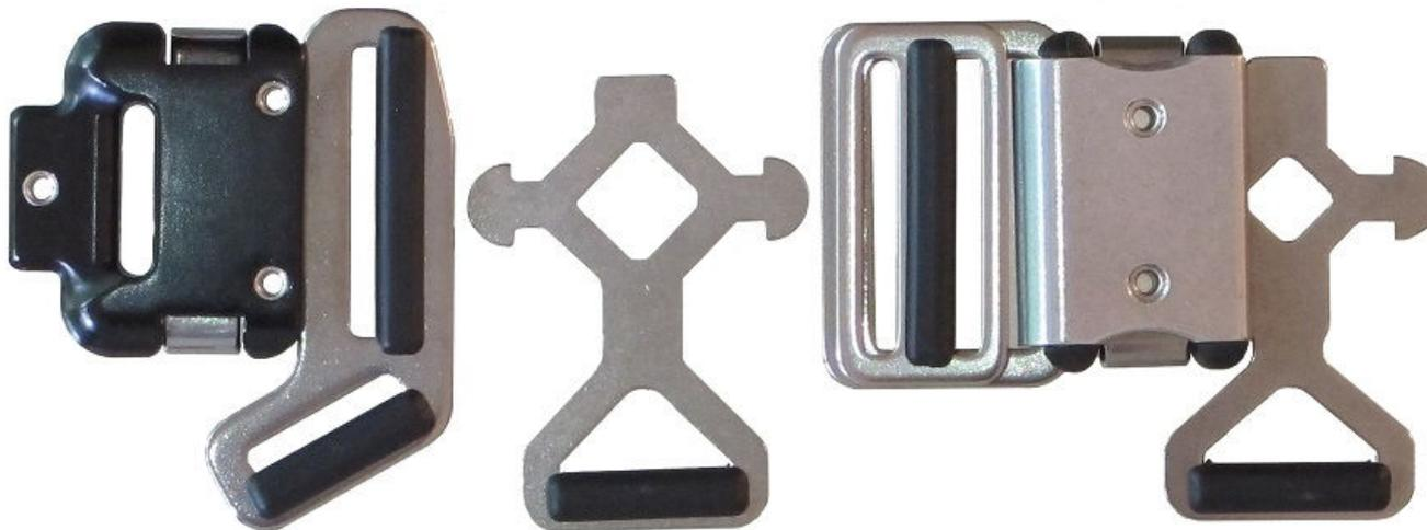
In den letzten 3 Monaten war es bei älteren Gleitschirmgurtzeugen zu zwei Vorfällen mit der am Brustgurt montierten Schließe CLICKLOCK (HSi10) gekommen. Sie hatte sich während des Fluges unter Belastung geöffnet. In einem Fall bei einem SAT-Manöver (Spreizen des Brustgurts durch Abstützen am Tragegurt), im zweiten Fall wahrscheinlich durch die Belastung mit dem Körpergewicht des nur in den Beingurten hängenden Piloten.
