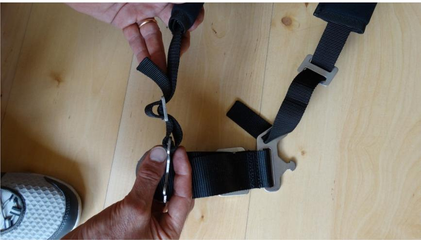
Setze den neuen Brustgurt ein, indem du die Beinschlaufen durch die Schnallen am Brustgurt (Vergewissere dich das die schwarzen Plastikteile in den Schnallen noch da sind) und dann durch die Einstellungsschnallen fädelst. Es ist sehr wichtig, das das Gurtband der Beinschlaufen überall flach liegt und nicht verdreht ist.
