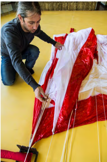
Abb. 62 Zweite Bahn dem Basisrand folgen
