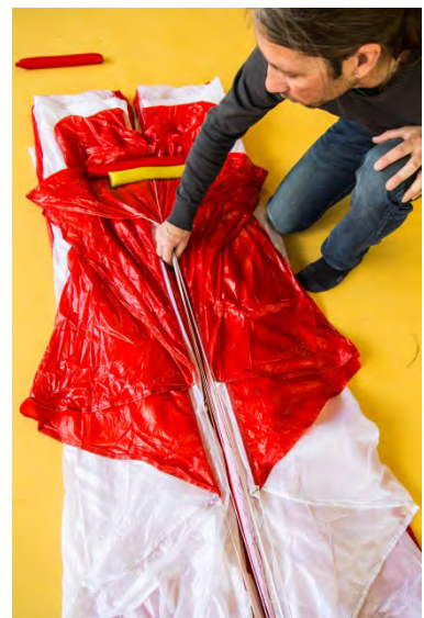
Abb. 85 Kontrolle über den freien Verlauf der Leinen...
