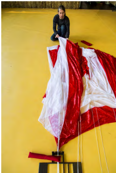
Abb. 68 Leine Bahn Nr. 3 im Faltrechen fixieren
