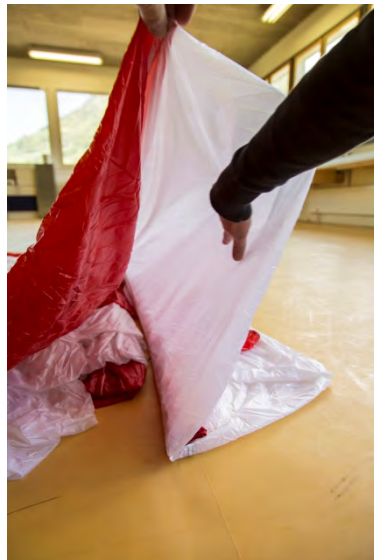
Abb. 69 Bahn Nr. 3 nach aussen streichen (S-Schlag)
