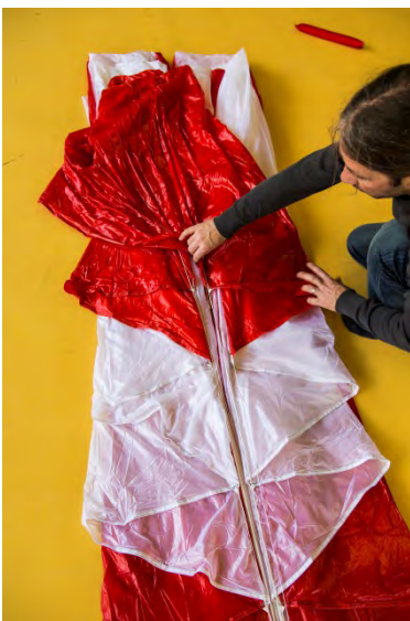
Abb. 83 identisches Falten der gegenüberliegenden Seite...
