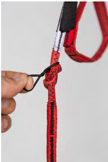
Abb. 9 O-Ring 2 x verdrehen
