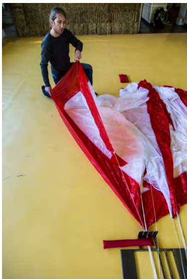
Abb. 56 Bahn Nr. 1 spannen
