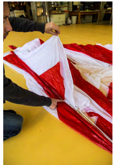
Abb. 64 Leinenansatzpunkt auf die Mittelleinen legen und fixieren
