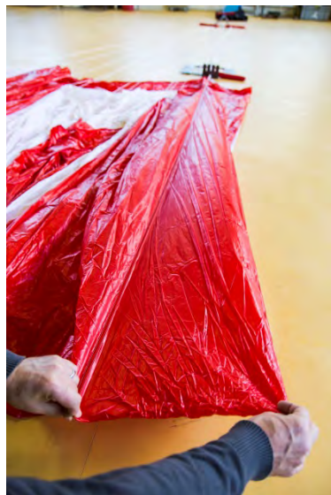
Abb. 72 Bahn Nr. 4 nach aussen legen (S-Schlag)
