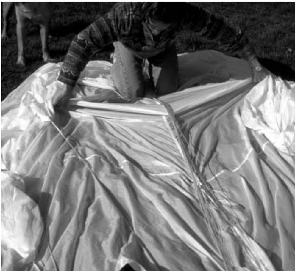
Jeweils ca. 50 cm des **beamer** liegt beidseitig der Schirmachse faltenfrei am Boden. Sämtliche Mittelleinen sind gestreckt. Das restliche Segeltuch zwischen den Mittelleinen-Aufhängepunkten wurde mittels Taschenbildung Richtung Schirmspitze gestrichen. Die Schirmspitze jetzt mit einem Bleisack fixieren.
