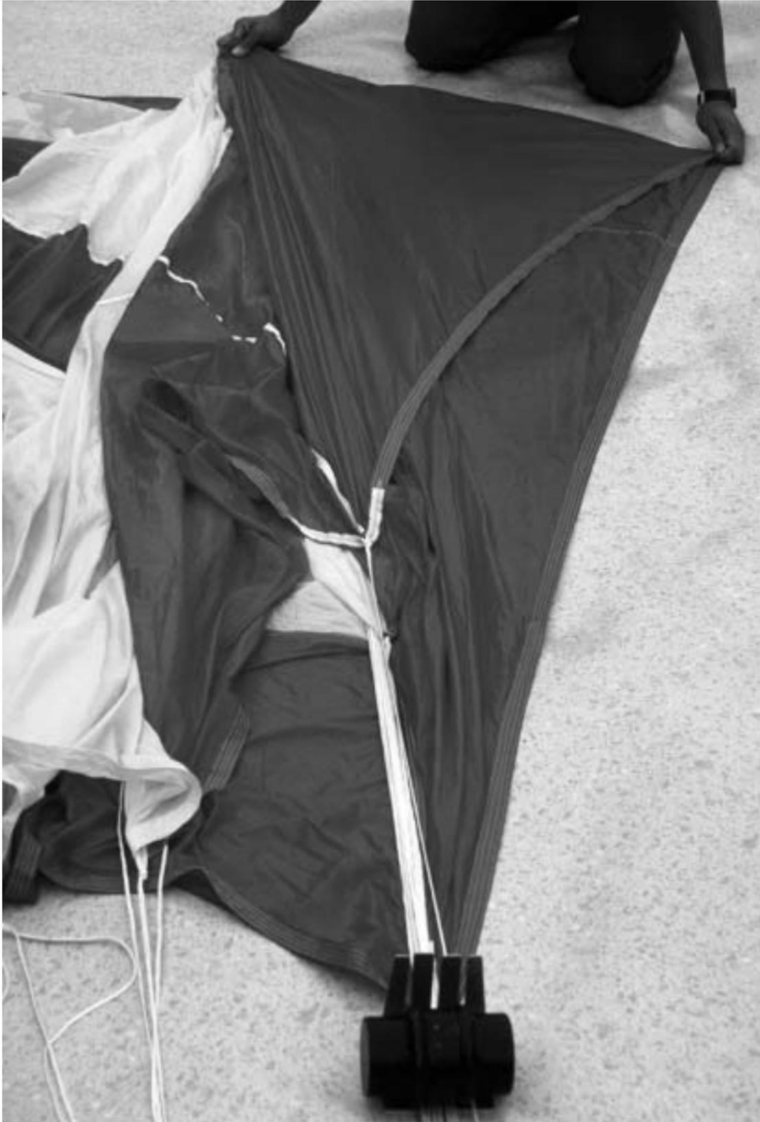
Basisrand von der Mittelleine der Austrittskante ergreifen. Die darauf folgende Leine (Bremse) wird nun durch den Faltrechen geführt und fixiert. Basisrand strecken und das Segeltuch mit der zweiten Hand spannen und auf die Mittelleine legen.
