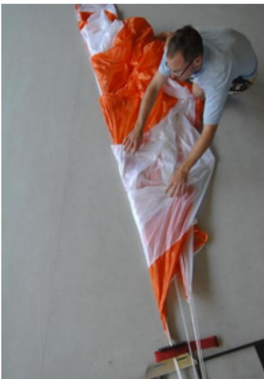
*Abb. 65* Die Mittelleinen bilden die Symmetrieachse
