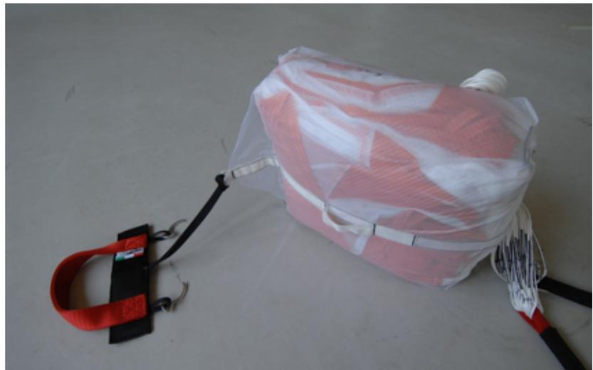
Abb. 108 Griffbefestigung für im Gurtzeug integrierten Container
