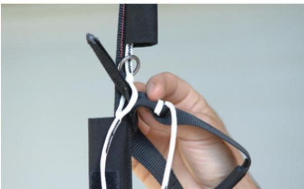
*Abb. 3* Verkürzen der Steuerleine für die angebremste Öffnungsstellung. Steuergriffposition „hoch“, Befestigung an der
