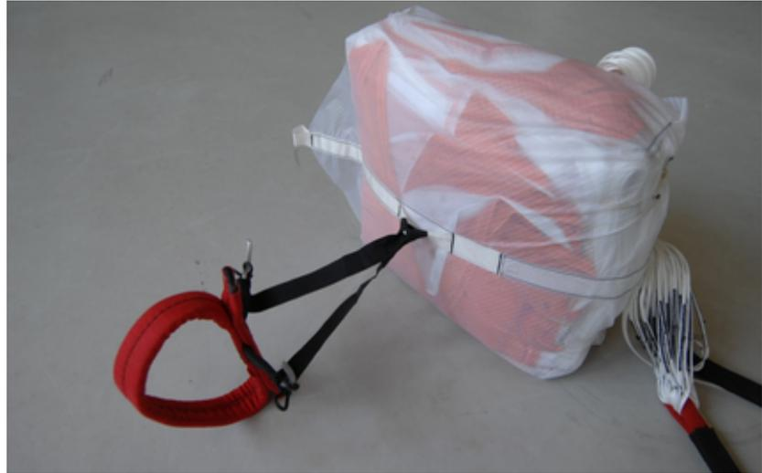
Abb. 112 Griffbefestigung für Frontcontainer
