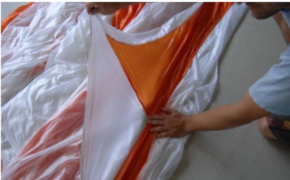
Abb. 36 Leinenansatzpunkt Bahn Nr. 2 auf die Mittelleinen legen und mit der Hand fixieren
