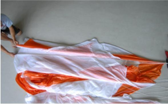
Abb. 34 Bahn Nr. 1 mittels doppeltem S-Schlag reduzieren
