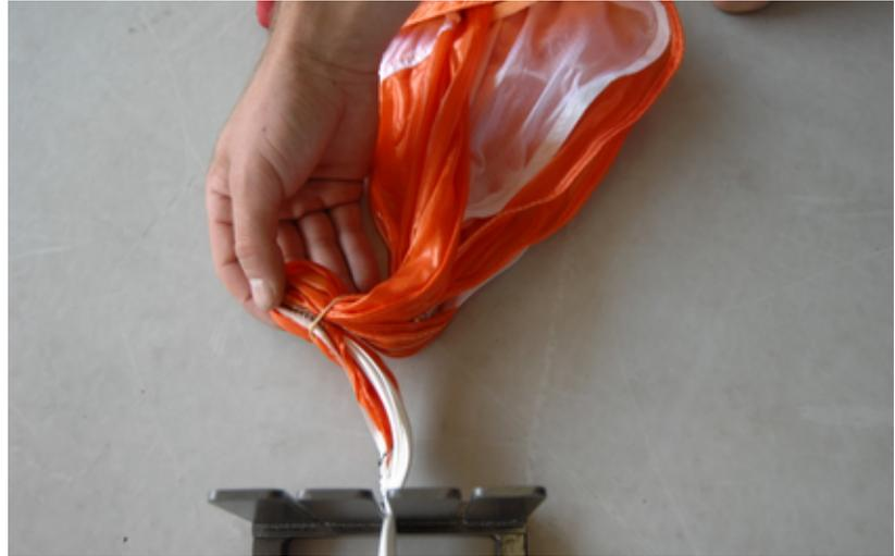
*Abb. 85-86* ...mit einem Gummi sichern und auf die Kappe legen
