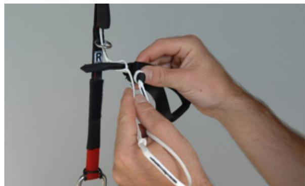
*Abb. 4* Verkürzen der Steuerleine für die angebremste Öffnungsstellung. Steuergriffposition „tief“, Schultergurtverbindung
