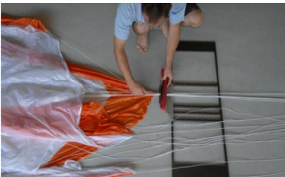
Abb. 32 Leine von Bahn Nr. 1 im Faltrechen fixieren. Abb. 33 Bahn Nr. 1 auslegen und darauf achten, dass die Leine auf die Mittelleinen und zugleich auf die Geräteachse zu liegen kommt. Form und Grösse dieses Panels können je nach Bremsleinenstellung variieren.
