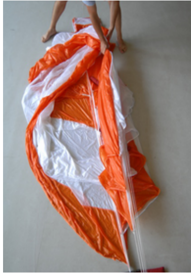
Fig. 63-64 Mettez l'autre moitié du parachute sur le côté déjà plié
