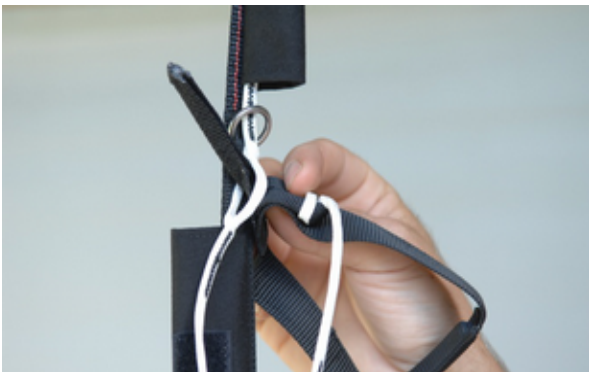
Fig. 3 Positionnement de la suspente de frein pour une ouverture freins tirés. (position ventrale)
