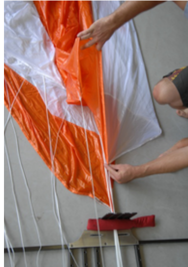
Fig. 45-46 Placez les suspentes du panneau N°4 dans le séparateur
