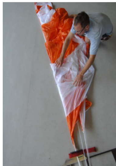
Fig. 65 Les suspentes centrales forment l'axe de symétrie
