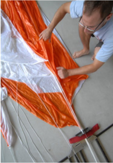
Fig. 50 Placez les suspentes du panneau N°4 dans le séparateur
