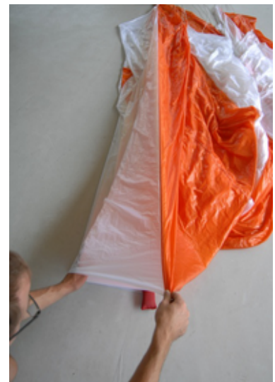
Fig. 43 Placez le au dessus du n°2 en appliquant une petite tension
