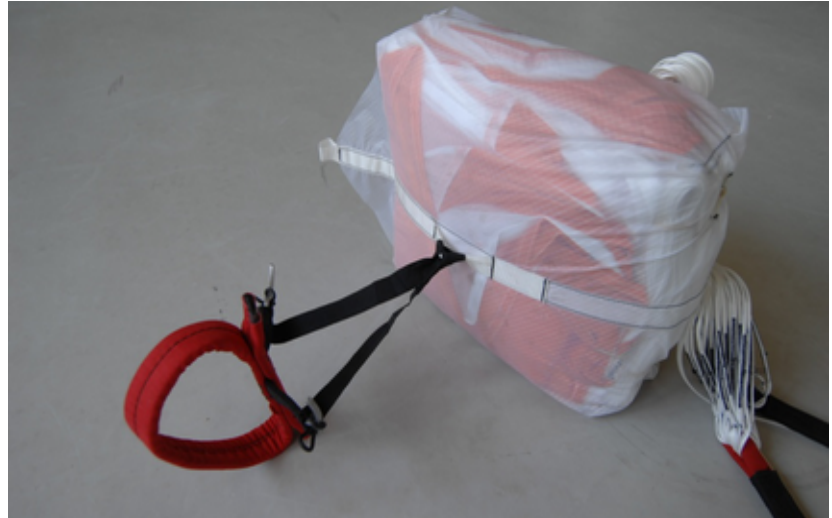
Fig. 112 Attache de la poignée pour une utilisation en container ventral
