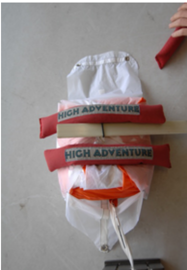
Fig. 97 Maintenez le pod avec un poids suffisant
