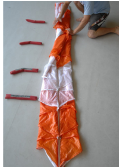
Fig. 79 Placez les deux côtés l'un sur l'autre
