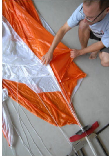
Fig. 51-52 le pliage des panneaux suivants jusqu'au bout d'aile suit la procédure décrite pour les panneaux 3, 4 and 5
