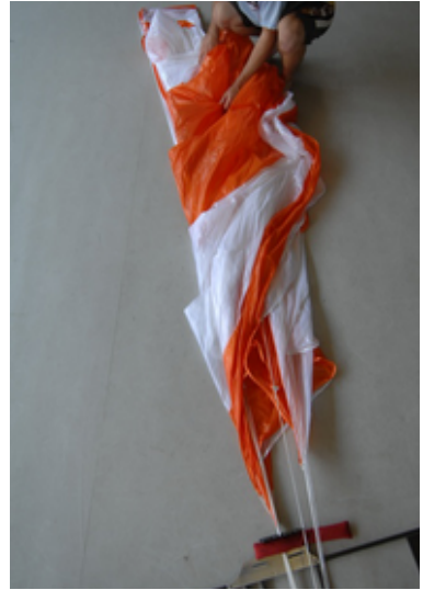
Fig. 63-64 Mettez l'autre moitié du parachute sur le côté déjà plié
