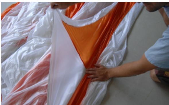
Fig. 36 Mettez la suspente avec son point d'ancrage du panneau n°2 au-dessus des suspentes centrales et maintenez les avec votre main
