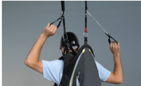
Fig. 2 Attache point d'ancrages prévus sur la sellette (généralement aux épaules)
