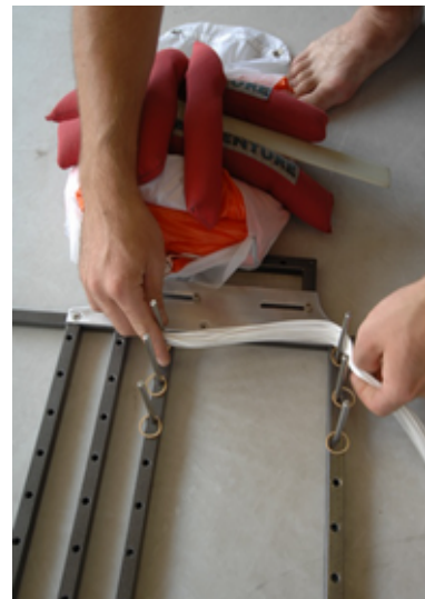
Fig. 99 Pliez les suspentes en huit... (attention a ne pas excéder la largeur du
