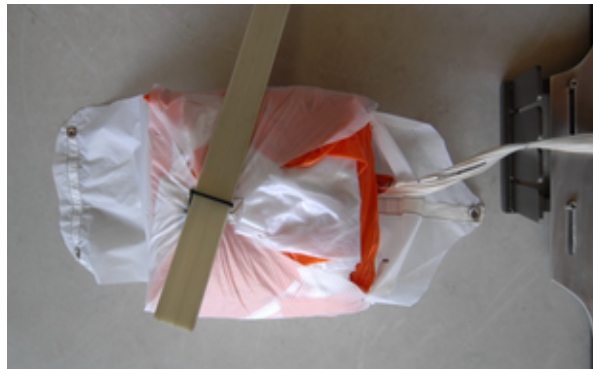
Fig. 96 Important: Le parachute doit être entièrement libéré dès que le premier volet est ouvert.
