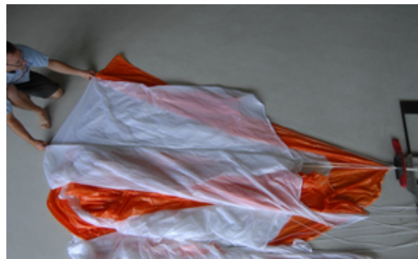
Fig. 32 Placez la suspente du panneau n°1 dans le séparateur. Fig. 33
