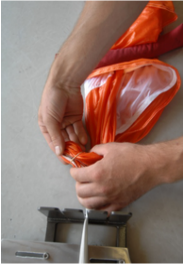
Fig. 85-86 ...et utilisez un élastique pour attacher le tout.
