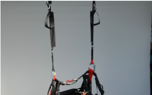
Fig. 1 Attache aux maillons principaux (pos. ventrale)
