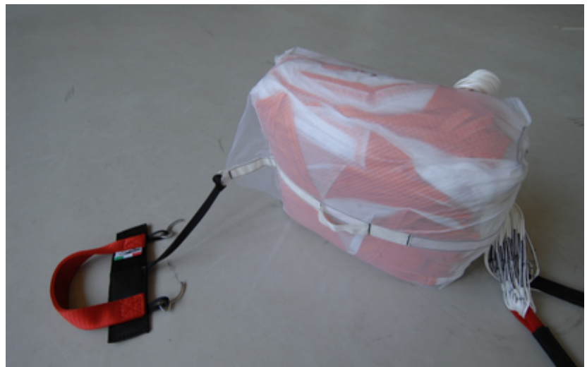
Fig. 108 Attache de la poignée pour une utilisation en poche de secours.
