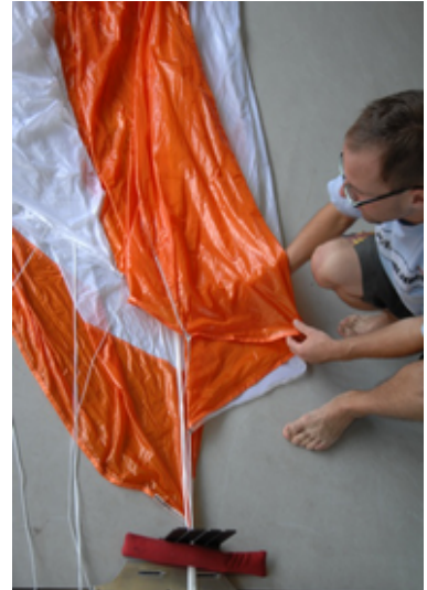
Fig. 45-46 Placez les suspentes du panneau N°4 dans le séparateur
