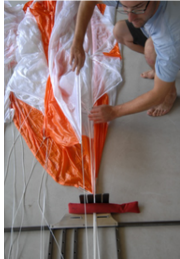
Fig. 39-40 Placez les suspentes du panneau N°3 dans le séparateur et mettez le au dessus des suspentes centrales.
