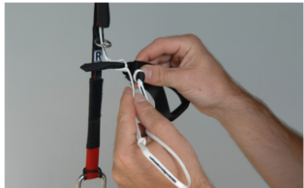
Fig. 4 Positionnement de la suspente de frein pour une ouverture freins tirés. (attache aux épaules)
