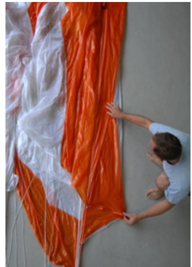
Fig. 48-49 Balayez le panneau 4 vers l'extérieur (pliage en S)
