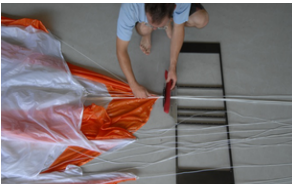
Fig. 32 Placez la suspente du panneau n°1 dans le séparateur. Fig. 33
