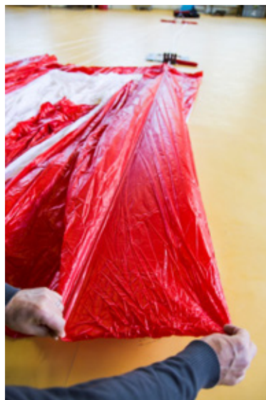
Abb. 72 Bahn Nr. 4 nach aussen legen (S-Schlag)
