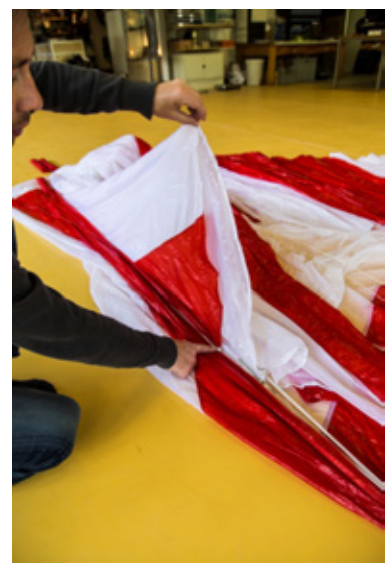
Abb. 64 Leinenansatzpunkt auf die Mittelleinen legen und fixieren
