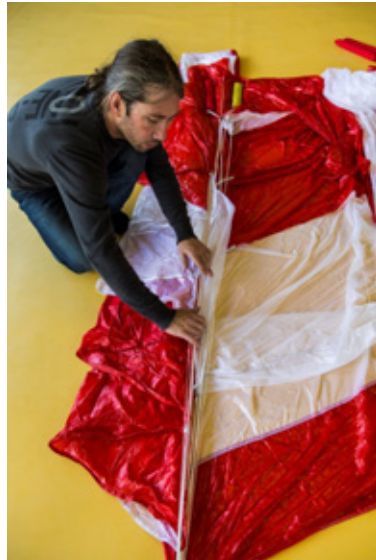
Abb. 78-79 herausquellender Stoff retour in die Bahnen schieben
