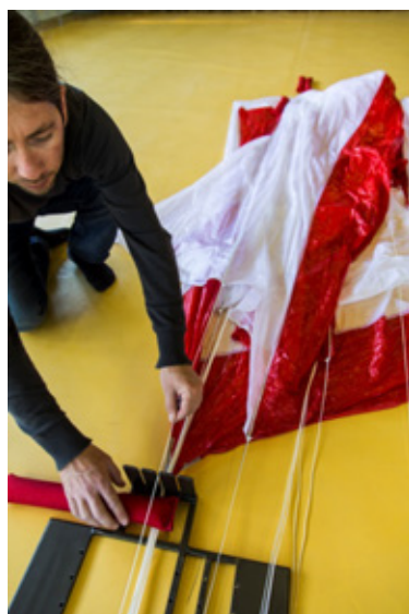
Abb. 63 Leine Bahn Nr. 2 im Faltschalen fixieren
