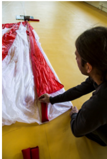
Abb. 59/60 ...S-Schlag reduzieren (beim Beamer 3 small nur halbieren)
