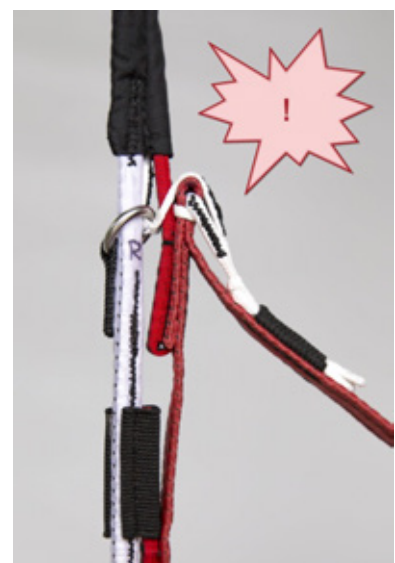
Abb. 16 Schnabel ausserhalb des Metallrings verstaen!
