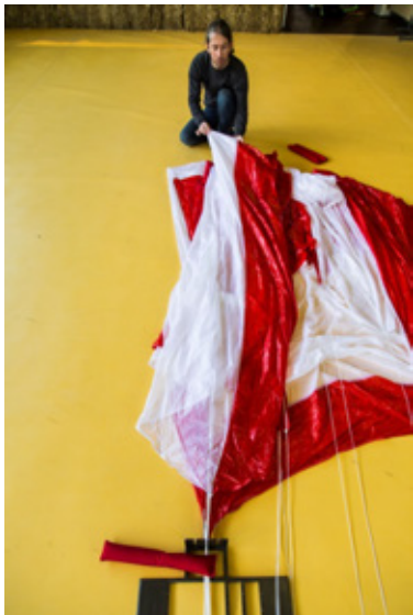
Abb. 68 Leine Bahn Nr. 3 im Faltrechen fixieren
