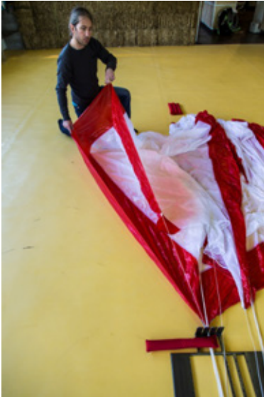
Abb. 56 Bahn Nr. 1 spannen
