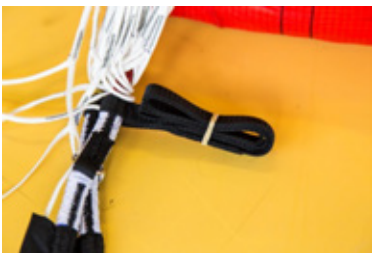
Abb. 134-137 Gurt-Verbindungssteg zweimal halbieren und mit einem Gummi sichern
