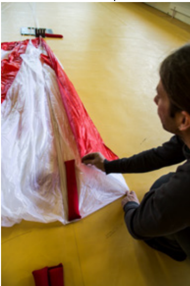
Abb. 59/60 ...S-Schlag reduzieren (beim Beamer 3 small nur halbieren)
