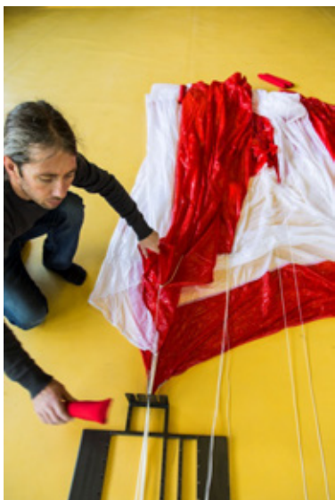
Abb. 71 Leine Bahn Nr. 4 im Faltrechen fixieren
