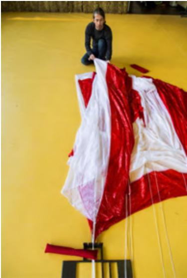
Fig. 68 Fijar suspenste del Panel 3 en el rastillo
