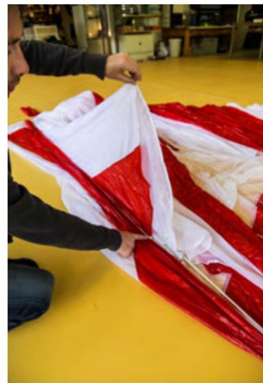
Fig. 64 Colocar la conexión del suspente del panel Nr.2 sobre las cuerdas centrales
