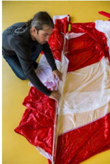
Fig. 78-79 Tela sobrante devolverla a los pliegues
