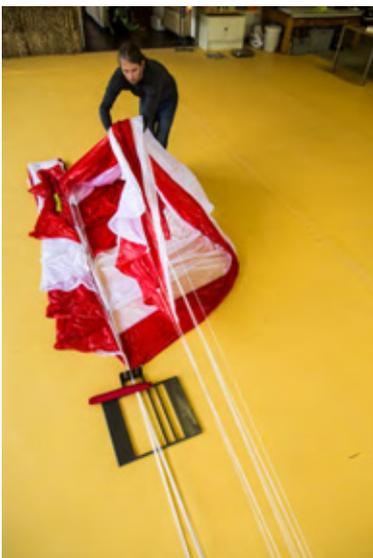
Fig. 80-82 Colocar la mitad de ala incluyendo los suspentes al lado opuesto sobre el rastillo
