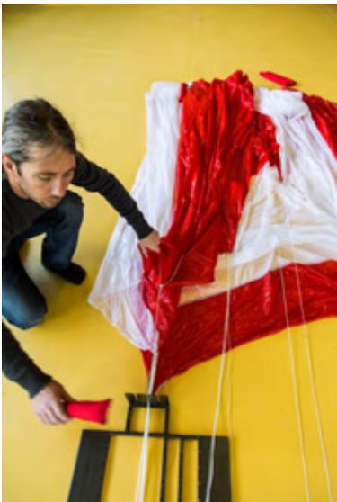
Fig. 71 Fijar suspenste del Panel 4 en el rastillo
