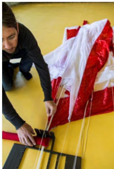
Fig. 63 Suspente Nr. 2 fijar en el rastillo
