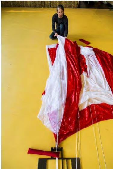
Fig. 68 Suspente du panneau #3 dans le séparateur
