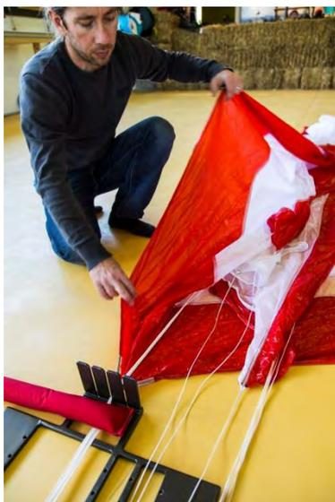
Fig. 54 Allez vers le bord de fuite, de la suspenste centrale vers la première suspenste
