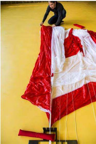
Fig. 74 Suspente dans le séparateur
