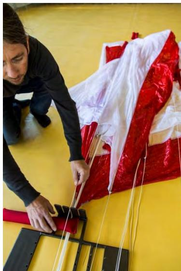
Fig. 63 Mettez la suspente du panneau #2 dans le séparateur
