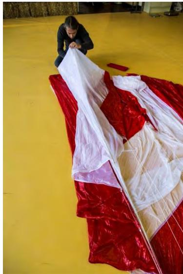
Fig. 75-77 Pliez les panneaux restants jusqu'au nez...
