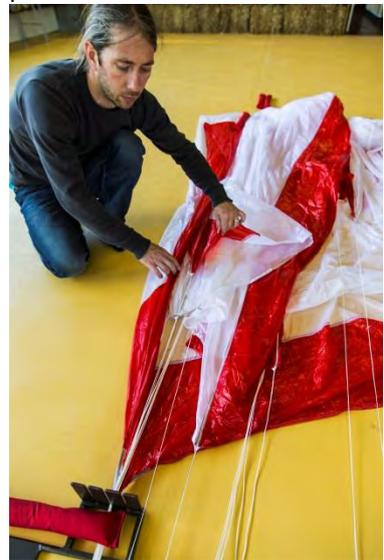
Fig. 61 Suspente #1 sur la suspente centrale
